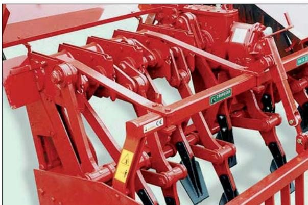
**È dotata di cambio di velocità a leva e presa di potenza posteriore. Tutti i supporti oscillanti sono a bagno d'olio per una lubrificazione ottimale.**
